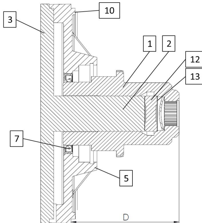
其主要的不同點在於端板(5)附有一個軸封(7)，這樣齒輪箱形成緊湊、封閉的單元。
