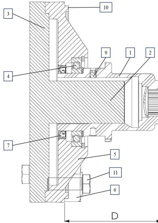
安裝在輪殼(1)上的滾珠軸承(4)是為了避免輪殼軸向位移。組裝時，將驅動輪殼(1)與端板(5)從齒輪箱殼體(6)上分離，將馬達(3)和輪殼裝配面清理乾淨。
